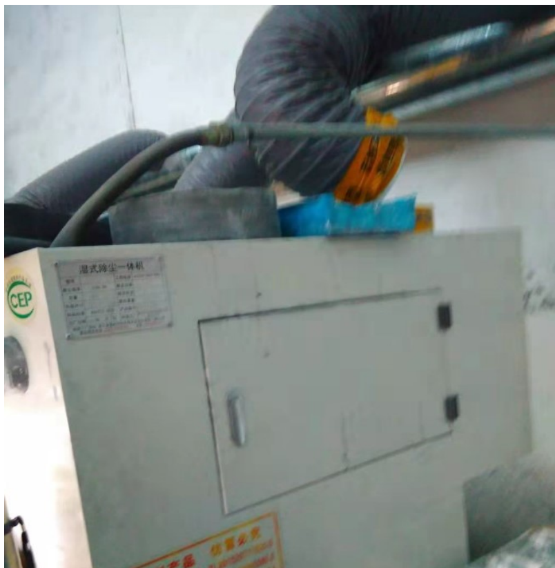
图 3-1 抛光机自带的布袋除尘器
