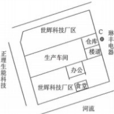
固定污染源无组织排放废气测点示意图
