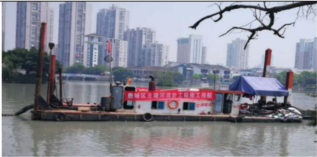
图 2-5 绞吸式挖泥船
