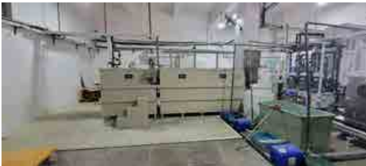
图 2.2-9 本单位蚀刻液循环再利用系统
