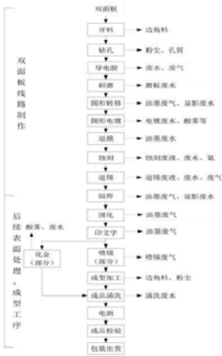
图 3.2-2 双面板生产工艺流程图
