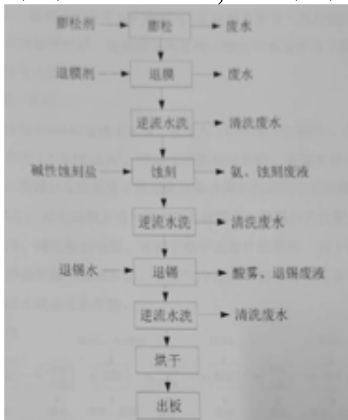
图 3.2-5 本单位退膜蚀刻退锡蚀刻线工艺流程
