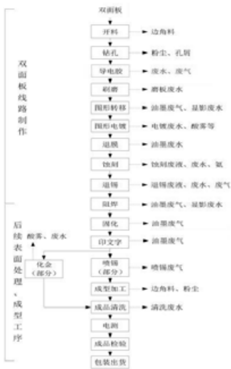
图 2.5-2 在产企业双面板生产工艺流程图
