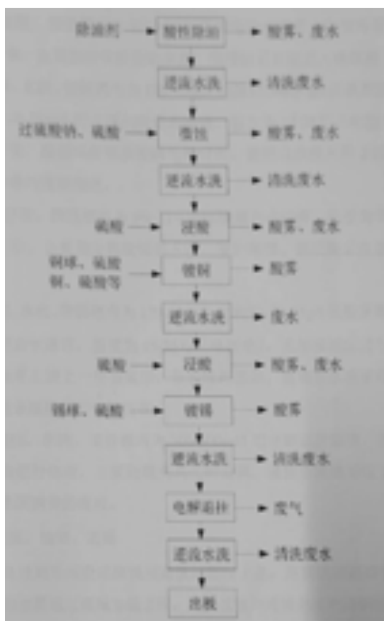
图 2.5-4 在产企业图形电镀工艺流程
