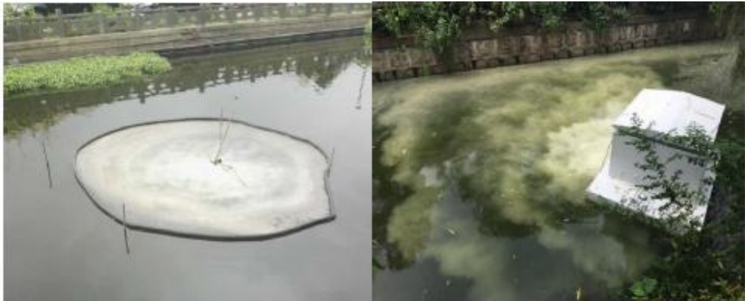
图 2-6 微纳米气泡水发生器运行效果图
