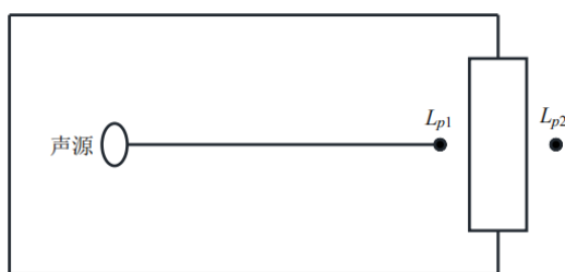
图 4-3 室内声源等效为室外声源图例
