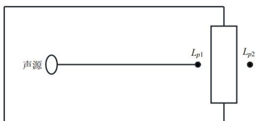
图 4-2 室内声源等效为室外声源图例
