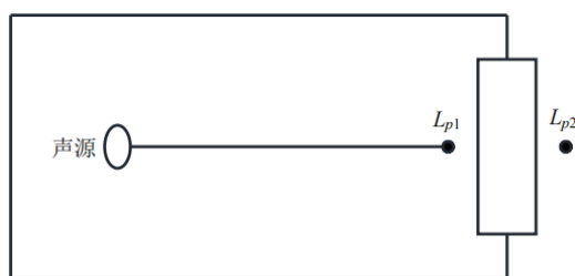
图 4-4 室内声源等效为室外声源图例
