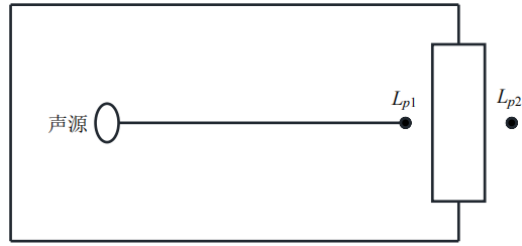
图 4-3 室内声源等效为室外声源图例
