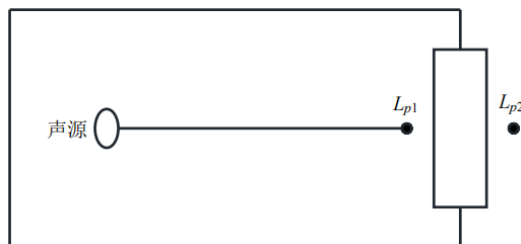
图 4-3 室内声源等效为室外声源图例
