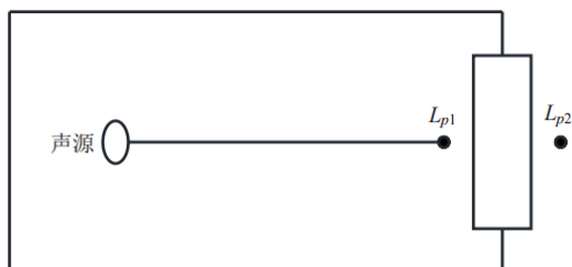
图 4-2 室内声源等效为室外声源图例
