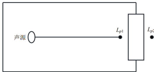
图 4-3 室内声源等效为室外声源图例
