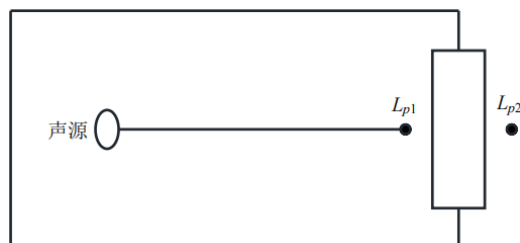
图 4-3 室内声源等效为室外声源图例
