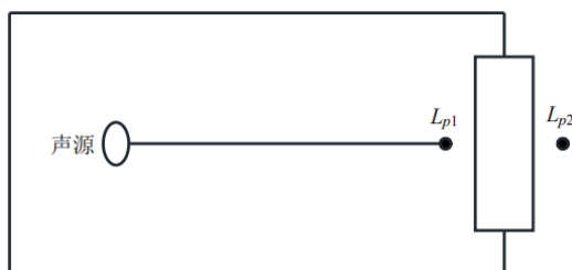
图 4-2 室内声源等效为室外声源图例
