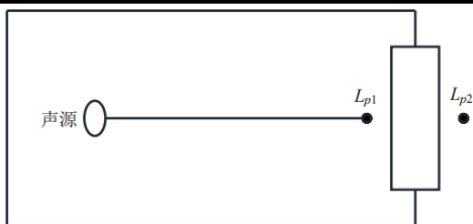
图 4-2 室内声源等效为室外声源图例
