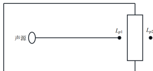
图 4-2 室内声源等效为室外声源图例
