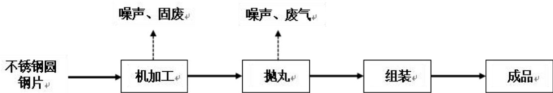
图 2-2 气阀组件工艺流程及产污节点示意图
