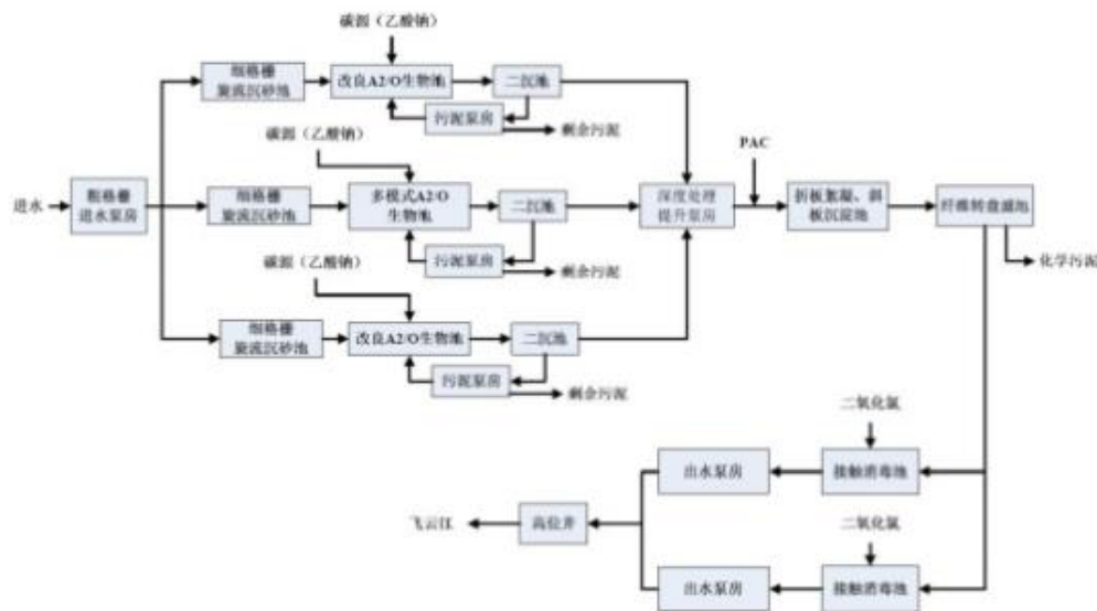
图 4-1 瑞安市江北污水处理厂处理工艺流程图
