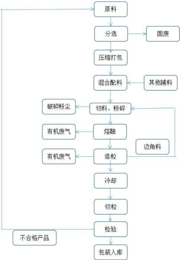
图 2-4 改性再生塑料颗粒生产工艺流程及产污节点示意图
