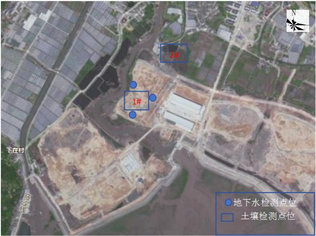
图 3-3 土壤和地下水检测点位图
