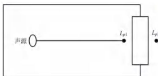
图 4-2 室内声源等效为室外声源图例
